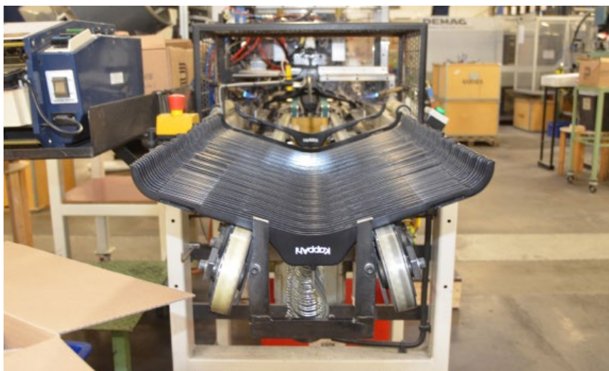
Bild från Nordic Hangers. Automatiseringsline för blushängare. På linen trycks firmamärket på galgen, friktionsstyrkor läggs på, metallkroken monteras och galgen får sin slutfinish. Foto: Björn Ohlsson
