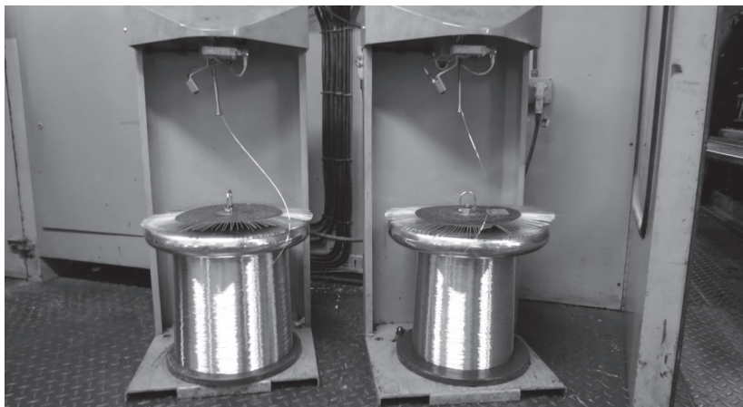
Trådrullen med stifttråd byts manuellt. Eftersom det är två rullar så kan en ta slut. Under tiden den rullen byts hinner alltid några tidningar få ett stift mindre men sen blir det två igen. Foto: Ida Dicksson.
