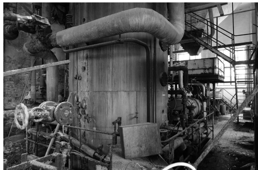
Världens första kontinuerliga massakokare installerades på Fengersfors bruk 1950. Foto: Eric Julihn.
