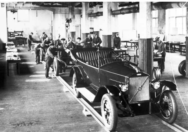
Vänster: Montering av modellen ÖV 4, vilket stod för »öppen vagn, 4 cylindrar«, i fabriken i Lundby på Hisingen 1927.
