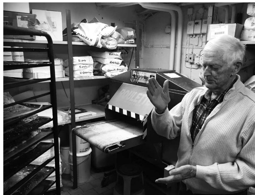
Gunnar Bergagård berättar om bageriet. I bakgrunden ses semmelsågen, som skär av hatten på semmelbullarna. Till vänster en stickvagn. Foto: Björn Ohlsson.
