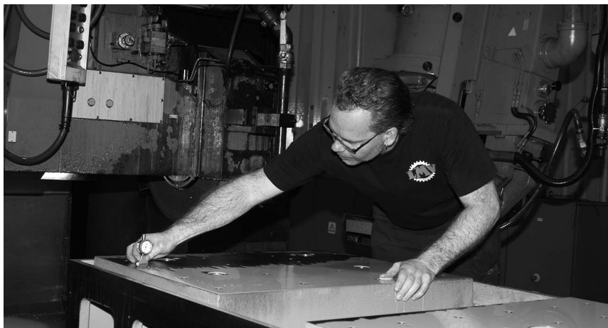
Kenneth Hagelin på Lidköpings Mekaniska Verkstad mäter djupet till ett o-ringspår, där det skall ligga en gummislang sedan. Han mäter med en hundradelsklocka, som är en djupindikerande klocka. Foto: Björn Ohlsson/Vänernumuseet 2014.
